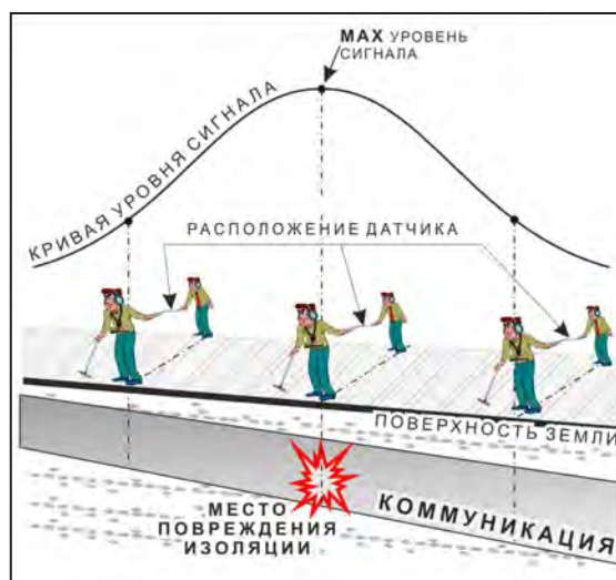
применение датчика-определителя дефектов коммуникации (ДОДК) методом max
