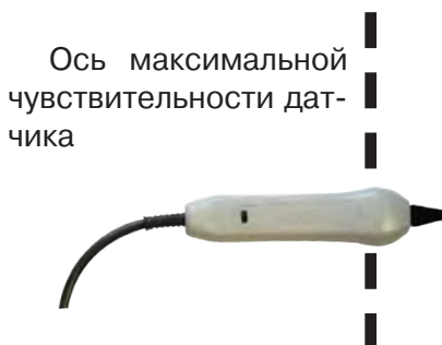
Выбор кабеля по максимальному сигналу
