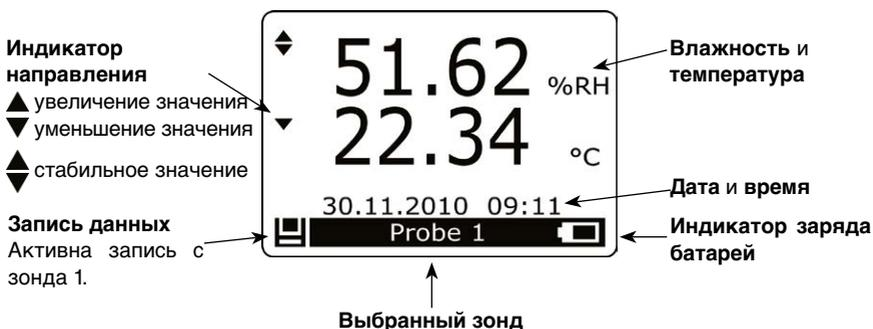
Выбор другого зонда, в отличие от отображаемого, или прокрутка значений измерений выполняются при помощи кнопок
